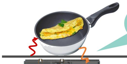
内蔵されているセンサーがフライパン底部の温度を感知して適切な調理温度をキープします。
